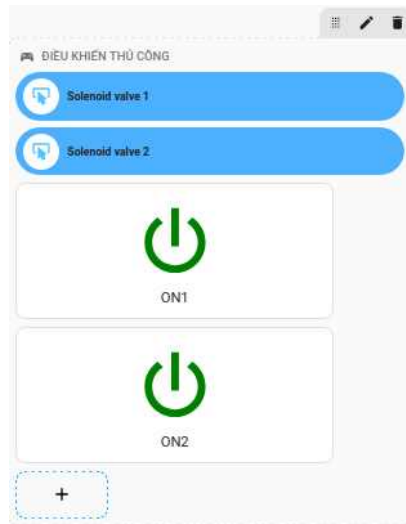
Hình 4.13 Nút điều khiển thủ công
