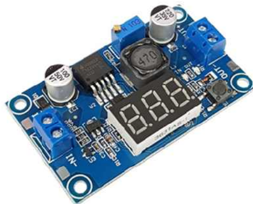
Hình 3.4 Module hạ áp LM2596S
